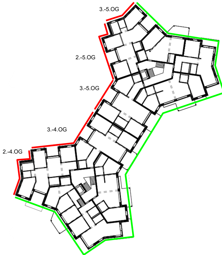
Abbildung 22: Fassadenabschnitt Bau Nord mit IGW-Überschreitung (rot) inkl. Angabe Geschoss
